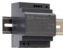
PS100-24, 100 W 230 V AC / 24 V DC 70 × 90 × 54,5 mm
