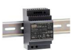
PS60-24, 60 W 230 V AC / 24 V DC 52,5 × 90 × 54,5 mm
